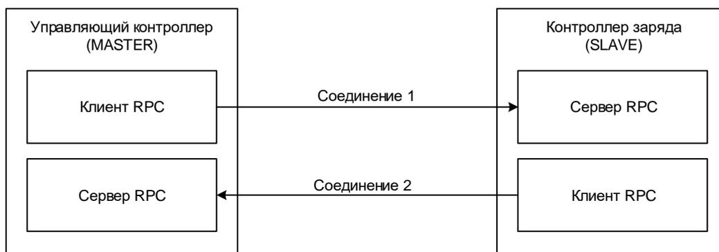
Обмен информацией между управляющим контроллером и контроллером заряда осуществляется по схеме Master-Slave, при этом контроллер заряда выступает в роли Slave. Для инициализации соединения клиент RPC управляющего контроллера подключается к серверу RPC контроллера заряда и выполняет метод «rpcConnectRequest»:
